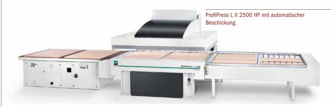
ine kompakte Verleimpresse mit Hochfrequenztechnik für Handwerk und Industrie hat Grecon Dimter Holzoptimierung Süd auf der Ligna erstmals vorgestellt. Die PPL II ist ideal für alle Hersteller hochwertiger Massivholzplatten.
